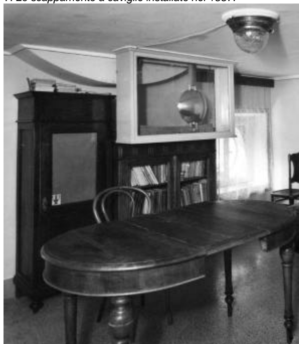
8. La lente del pendolo del 1857 che oscilla in una vetrina nella stanza sottostante al movimento.
