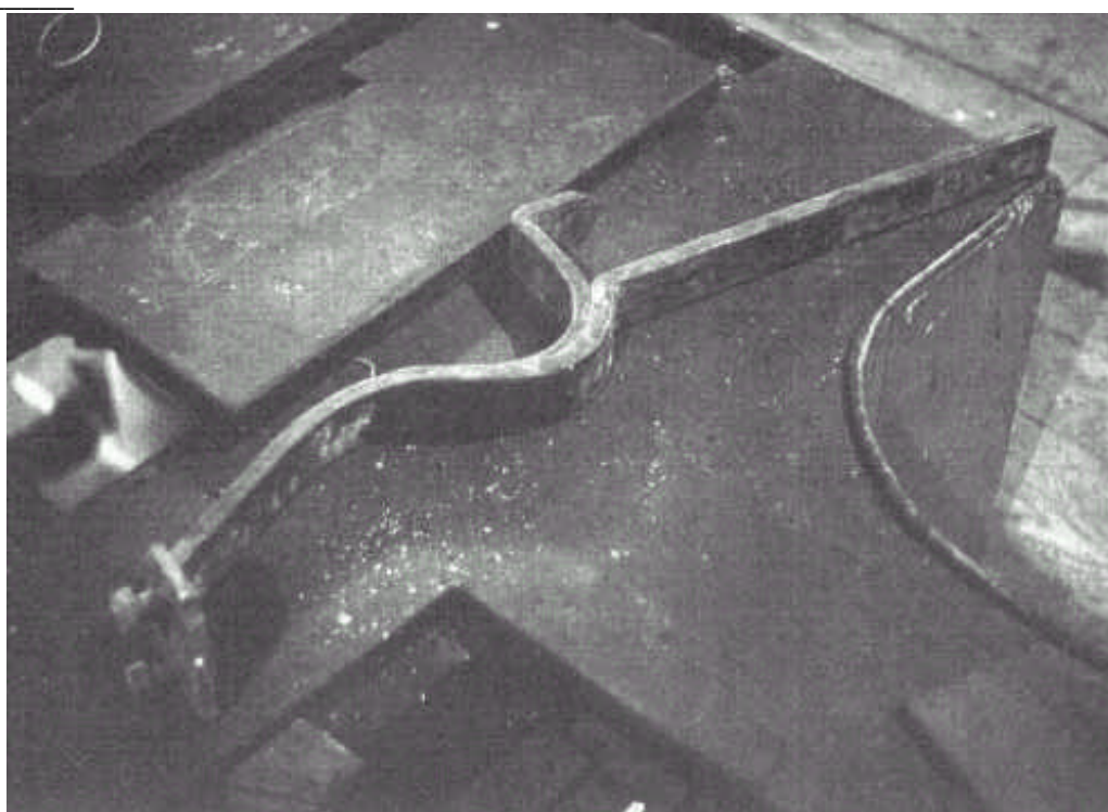
Il sostegno ferraciniano della sospensione del pendolo.
